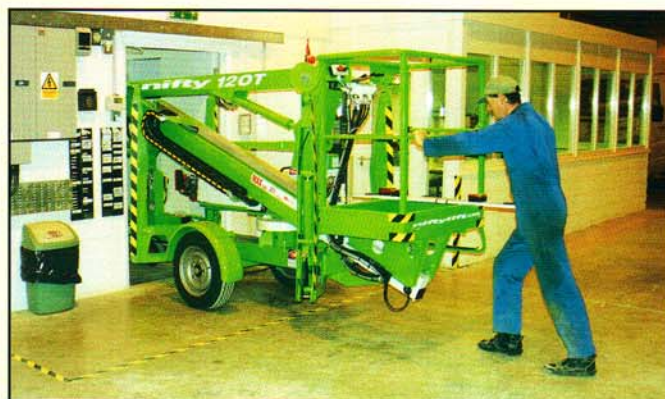
Teleskopachsen und kompakte Maße ermöglichen dem Nifty 120T ein einfaches Manövrieren auch in den engsten Bereichen.
