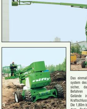
Das einmalige Aufhängungssystem des Nifty HR17 stellt sicher, dass auch beim Befahren von unebenem Gelände immer maximaler Kraftschluss vorhanden ist. Die 1,80m breite Plattform gibt dem Bediener ausreichend Platz für Werkzeug.
