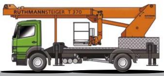
Die Bühnentragfähigkeit des T 370 liegt bei 500 kg. Somit ist er auch für Montage-/Reparaturarbeiten größerer Objekte bestens gerüstet.
